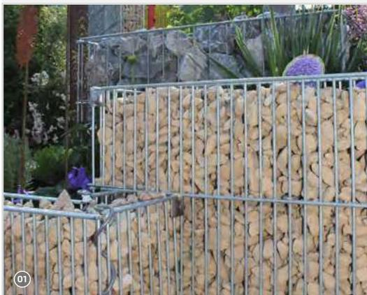
Material aus hochelastischer Baustahldraht in den Materialstärken, 3,5 mm, 450 N/mm<sup>2</sup> oder 4,5 mm, 450 N/mm<sup>2</sup>. Die Beschichtung besteht aus Galfan (95% Zink, 5% Aluminium), korrosionsbeständig nach DIN 50021-SS.
